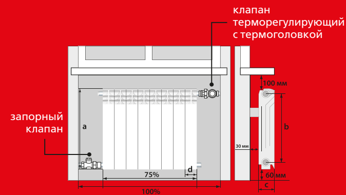
РИС. 2 РЕКОМЕНДУЕМЫЕ СХЕМЫ ПОДКЛЮЧЕНИЯ РАДИАТОРА К СИСТЕМЕ ОТОПЛЕНИЯ
