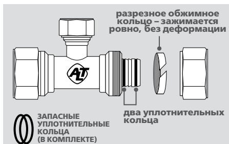
Рис. 1. Конструктивные элементы цангового фитинга
